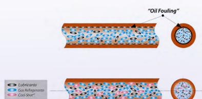
**Después:** Cool-Shot evita el efecto "Oil-Fouling" ya que elimina esta barrera aislante creada por el aceite, lo que permite al refrigerante estar en contacto directo con las superficies de transferencia de calor. Cool-Shot actúa como un catalizador lubricante sin alterar químicamente las propiedades del refrigerante.
